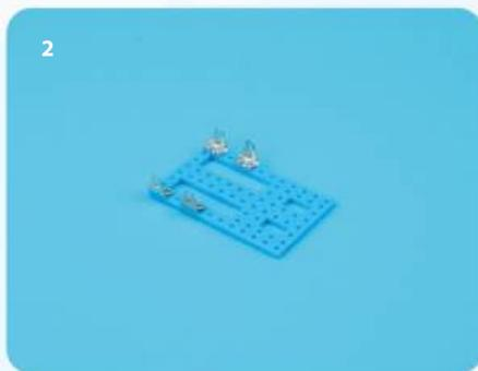
2. Используйте винты 4 мм, чтобы прикрепить 4 уголка к пластиковой платформе, между уголками отступите одно отверстие. Положение указано на рисунке.
