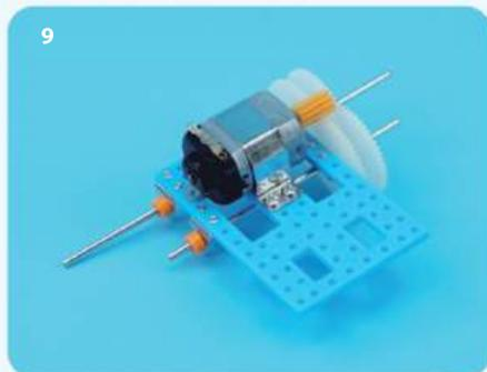
**9.** Прикрутите зажим для двигателя с помощью винтов. Закрепите так, чтобы шестерня на двигателе соприкасалась с шестерней на втулке 75 мм.
