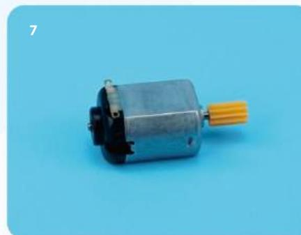
7. Закрепите желтую шестерню на двигателе.
