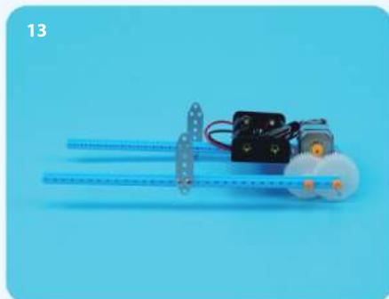
**13.** Используйте винты, чтобы закрепить пластины в середине стержней.
