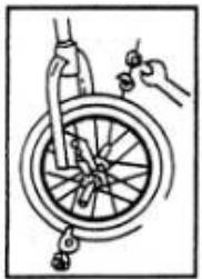
Установите переднее колесо в велосипедную вилку. Прикрутите страховочную шайбу. Соедините корпус и колесо. Отрегулируйте расстояние между передним колесом и рамой с обеих сторон.
