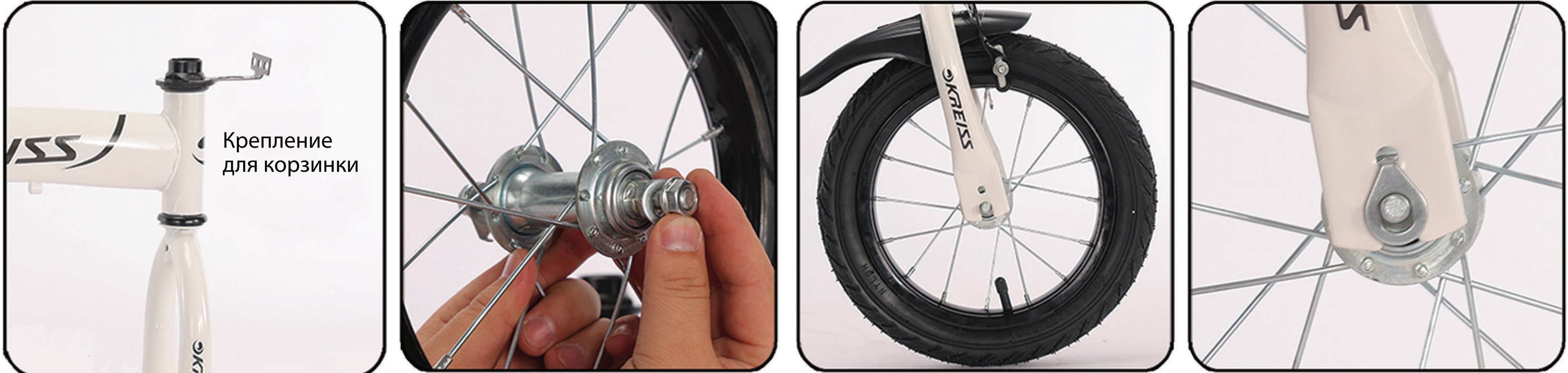
5. Выровняйте переднюю вилку. 6. Открутите гайку с переднего колеса и снимите хомут. 7. Установите переднее колесо на переднюю вилку. 8. Установите хомут для крепления переднего колеса.
