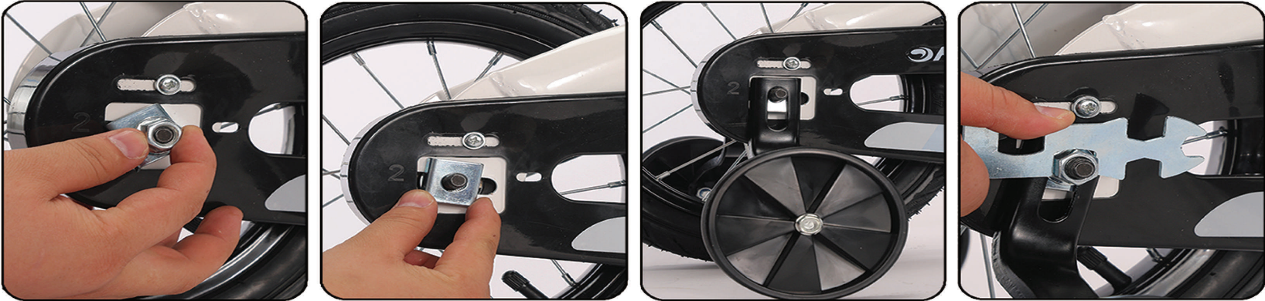
1. Открутите с двух сторон гайки для крепления боковых колёс. 2. Установите с двух сторон хомуты. 3. Установите боковые колёса. 4. Прикрутите гайки обратно и затяните их.
