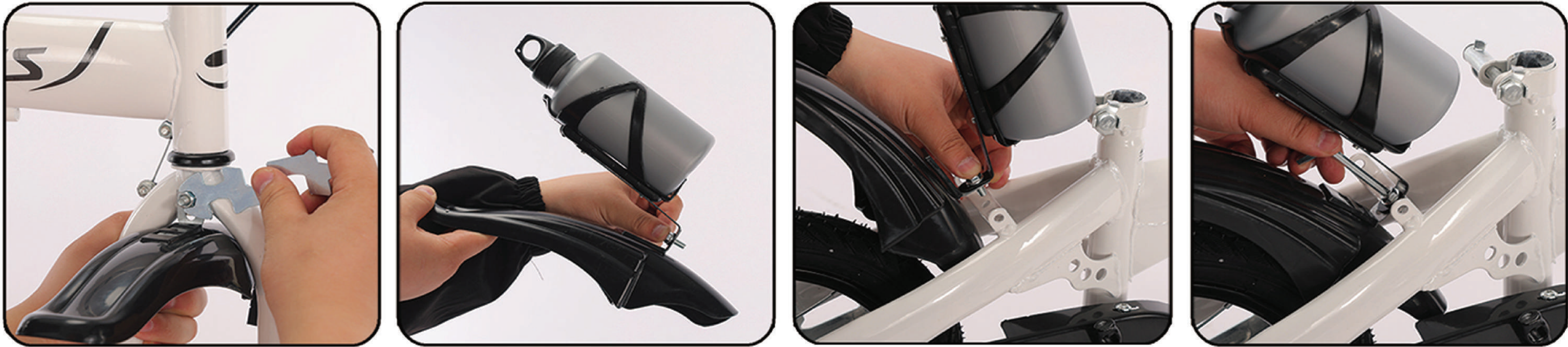
13. Прикрутите гайку и затяните её. 14. Установите держатель на заднее крыло и вставьте бутылочку. 15. Для крепления держателя используйте винты. 16. Плотно закрутите винты.
