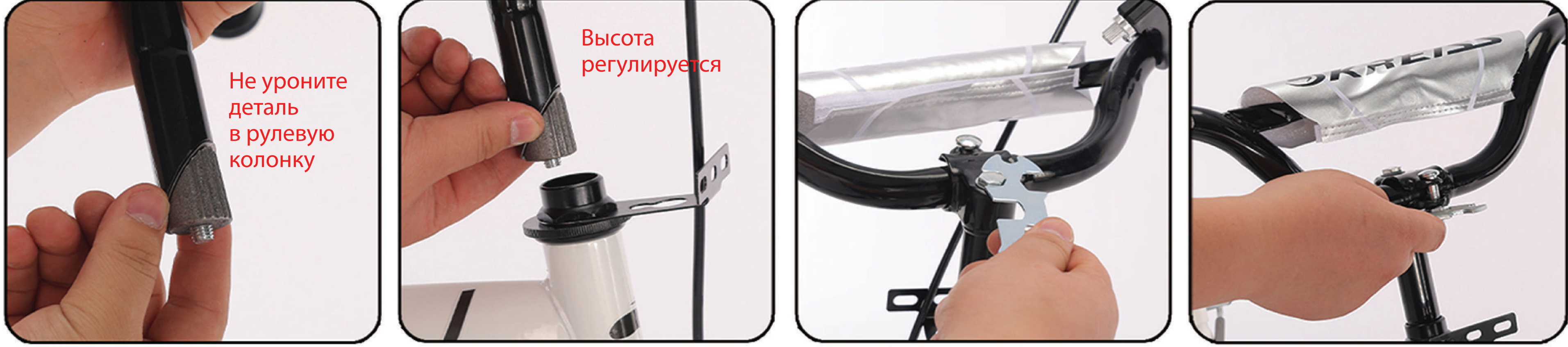
17. Выровняйте железный наконечник, как показано на рисунке. 18. Вставьте руль в рулевую колонку и отрегулируйте по высоте. 19. Затяните верхний винт. 20. Отрегулируйте угол наклона руля.
