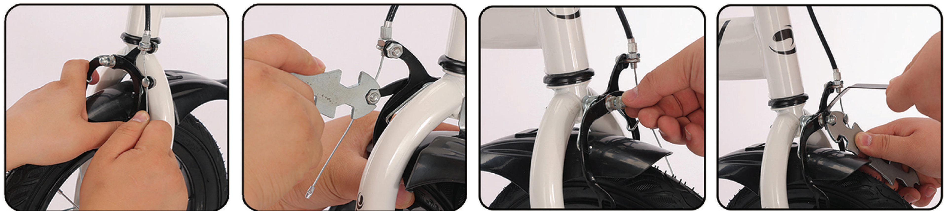
25. Нажмите на тормоз и натяните стальной трос. 26. Затяните гайки. горизонтально и затяните. 27. Ослабьте винт на переднем тормозе. 28. Установите нижнее крепление для корзинки на передний тормоз и затяните винт.
