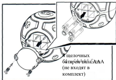
Схема размещения/установки батарей для смарт-мяча CHiP SmartBall™
