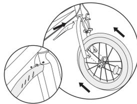
**2 Наденьте на болты переднего колеса контршайбы и гайки. Затяните гайки.**
