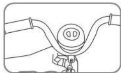
20. Открутите отсек для батареек с руля.
