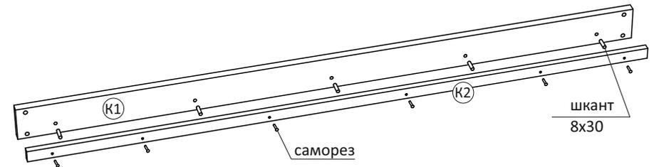
2.1 Собрать каркас кровати - соединить спинки кроватей п.1 с длинными царгами К1 на винты М6х90 и гайки-бочонки.
