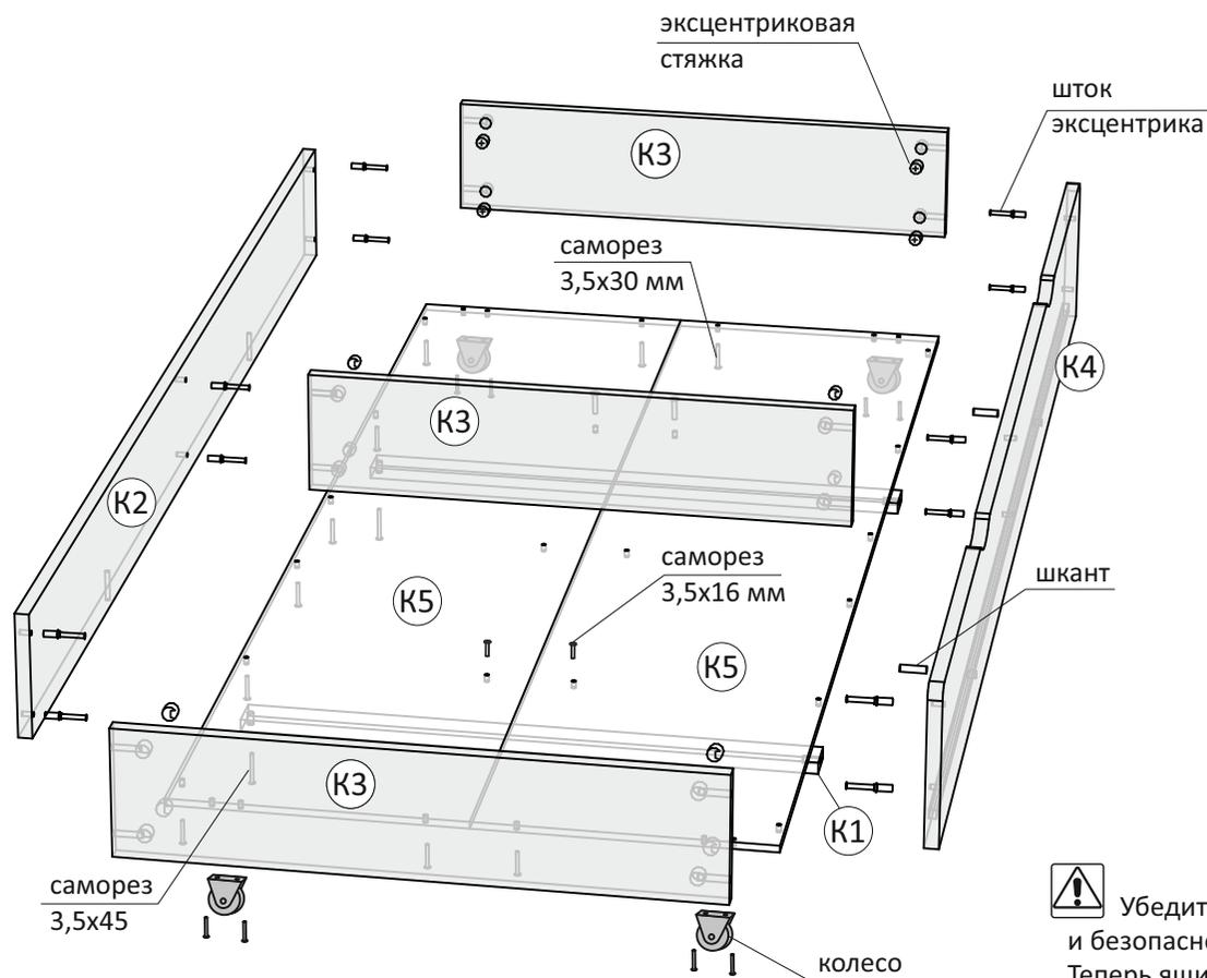
Порядок сборки соединений на эксцентриковые стяжки
