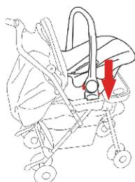
**УСТАНОВКА:** сопоставьте соединитель с отверстием на коляске, надавите на него до щелчка для блокировки конструкции.
