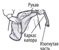
1. Вставьте каркас через отверстия в капоре.
