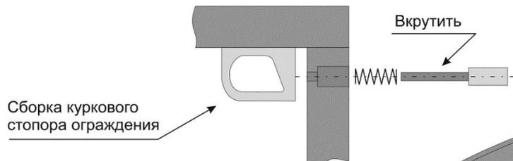
Потяните за курок с двух сторон ограждения. Поставьте переднее ограждение на направляющие планки. Опустите ограждение до верхнего отверстия в спинке
