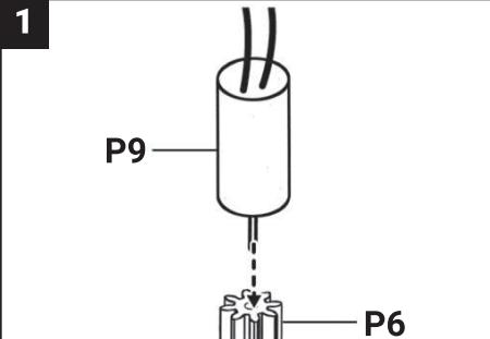
Установите ведущую шестерню на ровную поверхность и опустите ось мотора в отверстие на шестерне до упора
