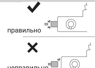
Некоторые заусенцы могут остаться на краях пластиковых деталей после того, как вы их отрезали. Убедитесь, что все заусенцы полностью удалены, чтобы избежать неисправностей при работе робота.
