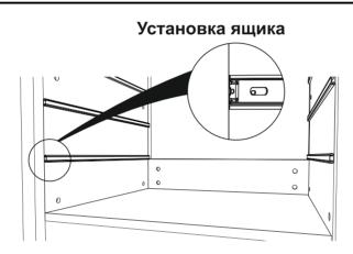
Установите ящики путем совмещения направляющих. Широкую часть направляющих выдвинуть до упора. Установить рельсы с обеих сторон равномерно и задвинуть ящик до конца. При правильном креплении ящика должен прозвучать щелчок.
