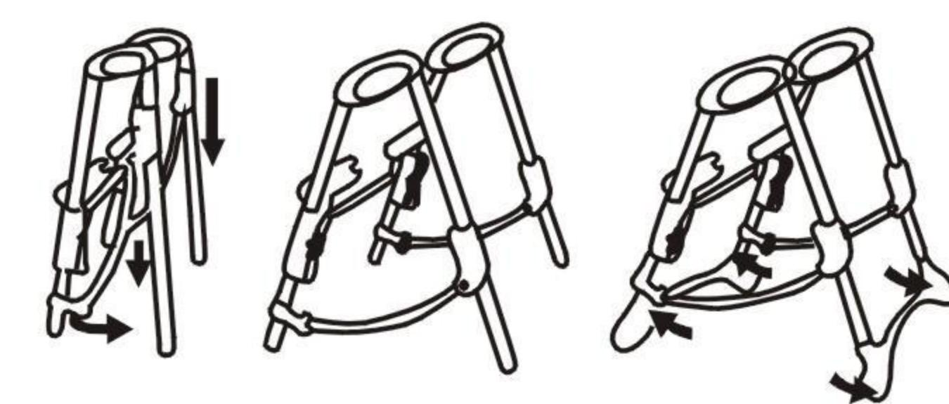
Нажмите одновременно на красные кнопки с задней стороны трубы, отодвинув заднюю ножку стойки, разложите стул для кормления.
