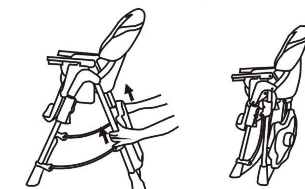
Для того чтобы сложить стул для кормления вам необходимо: Встать сзади стула для кормления и нажать на две красные кнопки. Подвиньте задние ножки к передним, пока стул для кормления не сложится полностью и не зафиксируется в том же положении.
