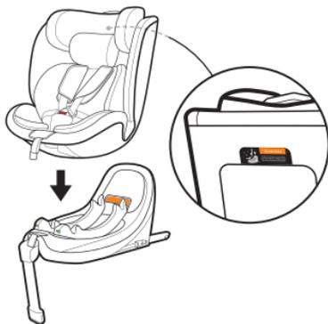
Для установки опустите автокресло на базу так, чтобы замки на нижней части основания защелкнулись. Проверьте индикатор: при правильной установке он будет зеленым.
