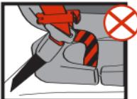
Надавите на автокресло так, чтобы оно плотно прилегало к спинке сиденья автомобиля. Натяните ремень безопасности по всей длине и зафиксируйте его диагональную часть с помощью фиксатора штатного ремня 6.
