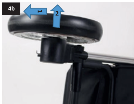
Демонтаж задних колес : вытяните рычаг заднего блока крепления « стрелка 1», извлеките заднее колесо в направлении «стрелки 2» Рис. 4б
