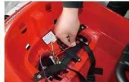
3: Подключение аккумулятора: подсоедините кабель питания и подключите красный разъем к красной клемме.
