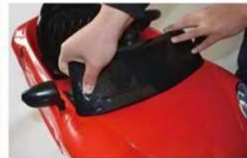
7: Установка переднего ветрового стекла: установите переднее ветровое стекло на кузов в направлении вниз.
