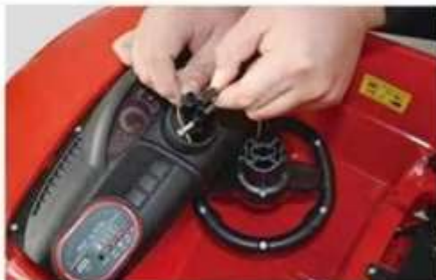
1: Подключение разъема для воспроизведения музыки: подключите кабель перед установкой рулевого колеса, как показано на фото.
