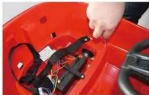
4: Установка сиденья: открутите винты от кузова.
