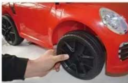
8: Установка колес: наденьте колесо на осевую накладку через отверстие в накладке.
