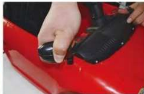
6: Установка зеркала заднего вида: установите зеркало заднего вида на кузов автомобиля в направлении вниз до щелчка.
