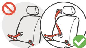
Соответствующая модель автомобиля должна быть оснащена ремнем безопасности с 3-точечным фиксатором ремня безопасности, требуемым GB14166 или ECE R16.
