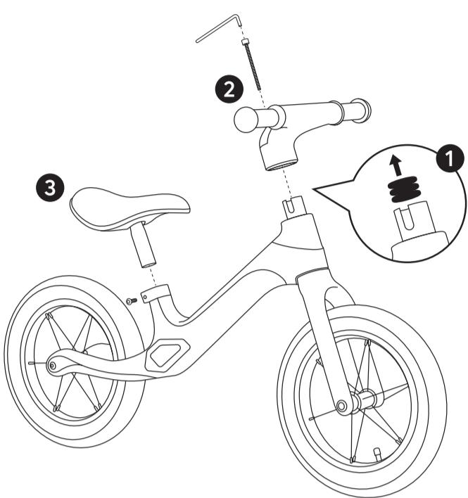
1 Извлеките пластиковую пломбу из рулевой трубы.
